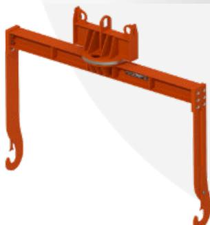
Il bilancino per bobine è costituito da una trave principale in acciaio ad alta resistenza e due elementi di presa laterali, fissati alla trave principale e dotati di dispositivo di anti sganciamento della bobina. Verniciatura protettiva con antiruggine e due mani di smalto (arancione RAL 2004 a richiesta verniciature con RAL differenti). Completo di dichiarazione di conformità alla normativa CE, manuale di uso e manutenzione.
