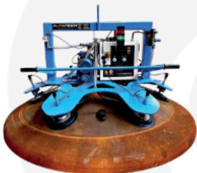
Struttura portante in tubolare di acciaio ad alta resistenza, maniglione centrale nel quale è installato il comando di presa e rilascio del carico tramite valvola a corsoio con blocco di sicurezza. A richiesta è disponibile radiocomando e pulsantiera pensile di scorta
