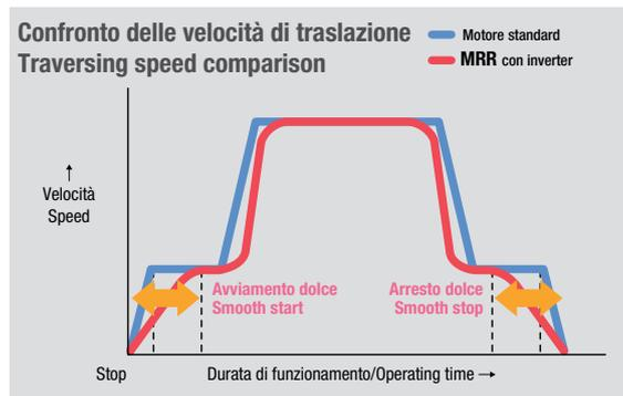
Oltre alla velocità, sul carrello con inverter a 2 velocità si può regolare anche il tempo di accelerazione e decelerazione.
