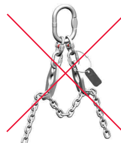
Applicazione sbagliata Wrong application
