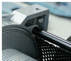
Protezione tamburo regolabile in funzione dell'angolo di uscita della fune. Drum protected by perforated plate, adjustable according to the outlet of the rope.
